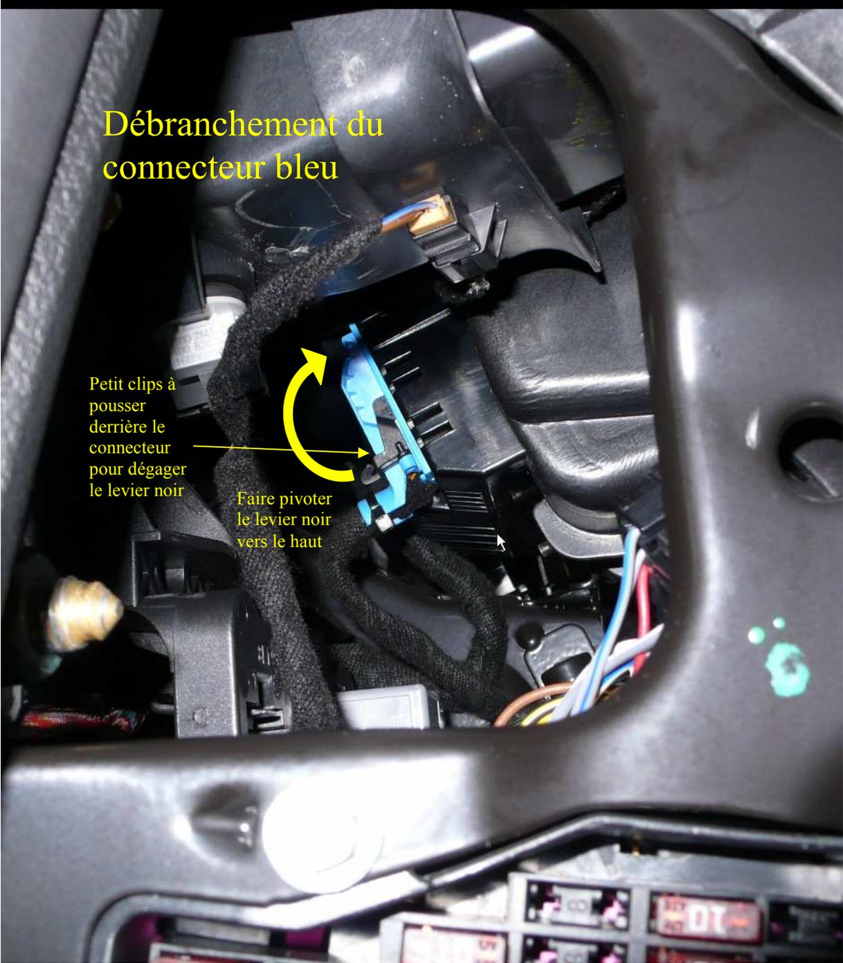
Ouvrir le connecteur en coupant le collier plastique et en tirant la languette rose :
